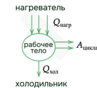
**Тепловая машина (двигатель)** – это циклически действующее устройство, превращающее теплоту в работу
